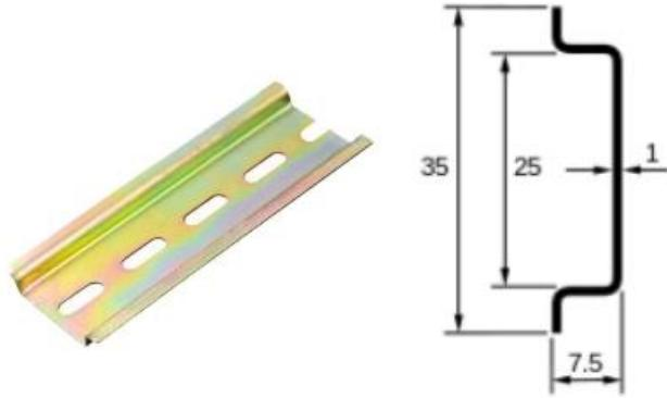
步骤2. 将设备 DIN 安装槽的上端卡入 DIN 导轨的上端，用力按压设备，将设备 DIN 安装槽的下端卡入 DIN 导轨的下端。
